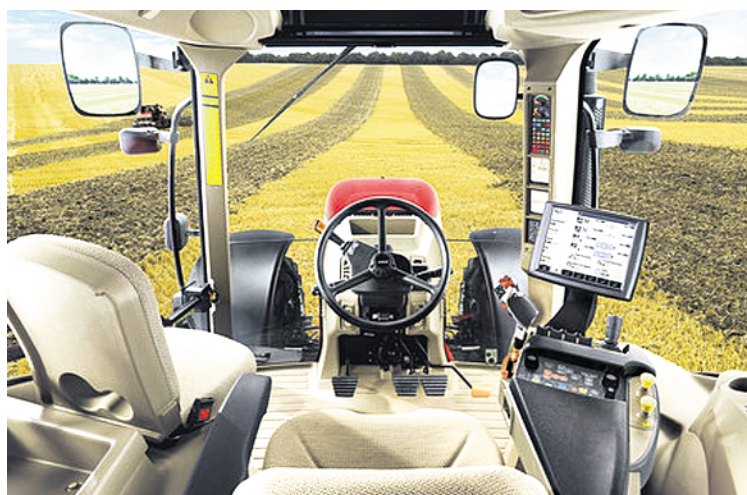
Moderne Traktoren sind heute Hightech pur. Die meisten Arbeitsgänge, so das exakte Anschlussfahren bei Bodenbearbeitung und Aussaat, werden entsprechend der betriebsindividuellen Vorgaben elektronisch überwacht und gesteuert. Eine hohe technische Qualifikation der Landwirte und Lohnunternehmer sowie deren Mitarbeiter ist unerlässlich. Foto: caseih
