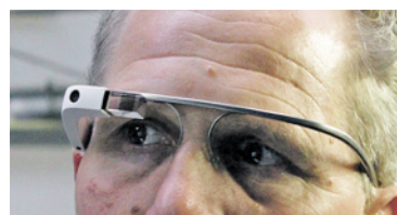
Mit der Brille SAC-Glasses hat der Milcherzeuger alle Kuhdaten direkt im Blick. Foto: sac
