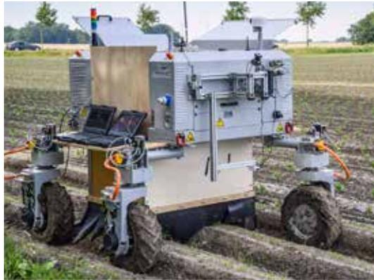
BoniRob bei der Arbeit auf dem Feld: Die Maschine kann zwischen Nutzpflanzen und Unkraut unterscheiden. Letzteres wird zielsicher mechanisch vernichtet. Auf der Freifläche der Landwirtschaftskammer wird der BoniRob vorgestellt.
