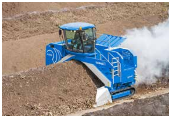
Mit einem Dreiecksmietenumsetzer können Kompostmieten bequem umgesetzt werden. Foto: eggemann
