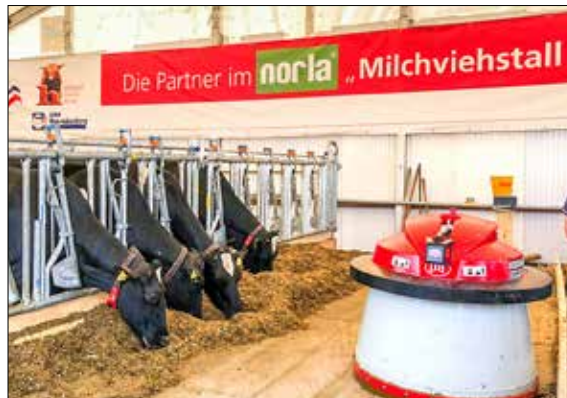
Die Kühe schieben auf der Suche nach den schmackhaftesten Bissen das Futter von sich weg – der Roboter kehrt in kurzen Abständen das frische Futter wieder vor die Kühe.
