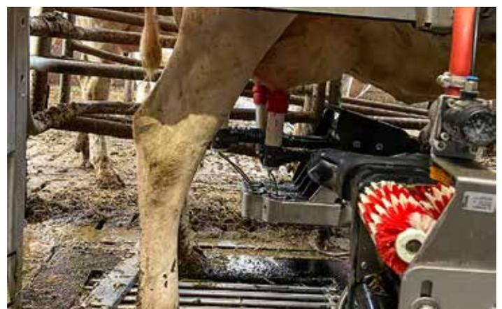
Vier Melkroboter melken im Stall Gravert die 240 Milchkühe den ganzen Tag. Im Roboter bekommen die Tiere eine auf sie abgestimmte Kraftfutterration.
