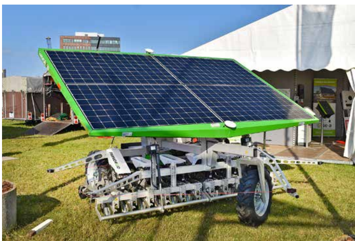
Auf dem Acker gibt es erste serienmäßige Roboter, die präzise Unkräuter bestimmen und entfernen können.
